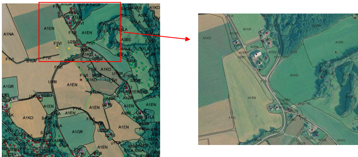
Figur 6: Kart konstrueres fra flybilder i en digital fotogrammetrisk arbeidsstasjon og det brukes en tolkingsinstruks som gir regler for hvordan man skal sette grensene for de ulike arealfigurene. Grensene tegnes inn som et eget datalag oppå bildet, slik bildet til venstre viser. Disse figurene, punktene og linjene har en eksakt lokalisering og en kode som forteller hva de er, og de danner så grunnlaget for produksjon av kart. I andreomdrevs registrering legges kartene opp på nye flybilder, som vist i utsnittet til høyre. Da blir endringene synlige og nytt kart konstrueres basert på den gamle.
