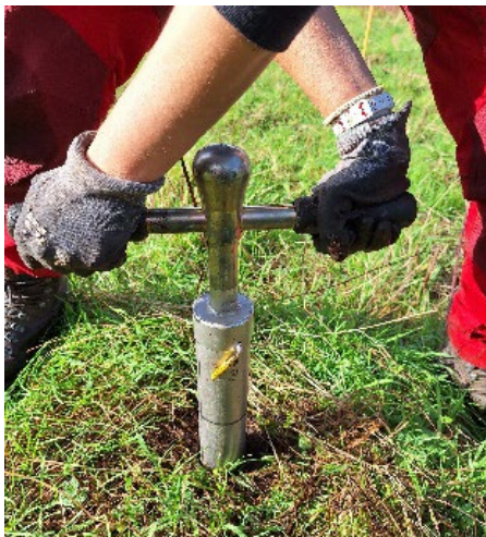
Figur 31: ... helt til jordoverflaten er på nivå med merket på utsiden av split-tube-jordboret (Fotograf: Dorothee Kolberg)
