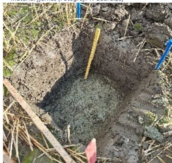
Figur 14: Etter at 2 sylinderprøver er tatt og penetrasjonsmålinger er gjort på 10 cm dybde, gjentas prosedyren på 30 cm dybde (Fotograf: Dorothee Kolberg)
