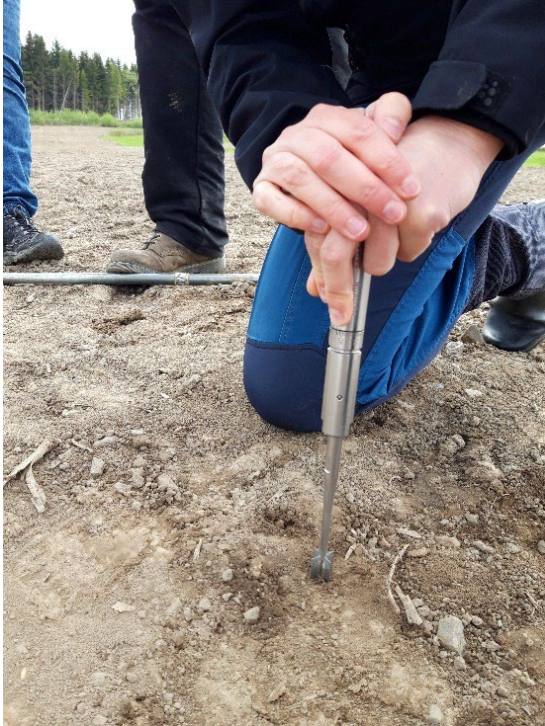
Figur 26: Skjærfastheten måles ved å stikke vingeboret loddrett ned i jorda, slik at vingebudet er akkurat under jordoverflaten (Fotograf: Teresa G. Bárcena)
