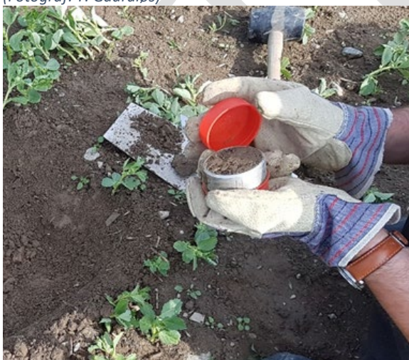
Figur 13: Det settes lokk på begge sider av sylinderen (Fotograf: T. Gaardløs)
