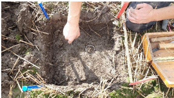
Figur 15: Penetrasjonsmotstand måles med lommepenetrometer mellom sylindrerne, etter at disse er slått inn (Fotograf: Teresa G. Bårceña)
