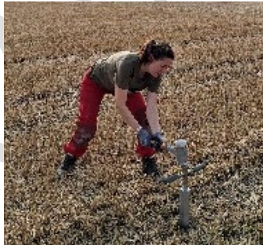
Figur 32: Bruk eventuelt hammer for å få inn split-tube-jordboret (Fotograf: Dorothee Kolberg)
