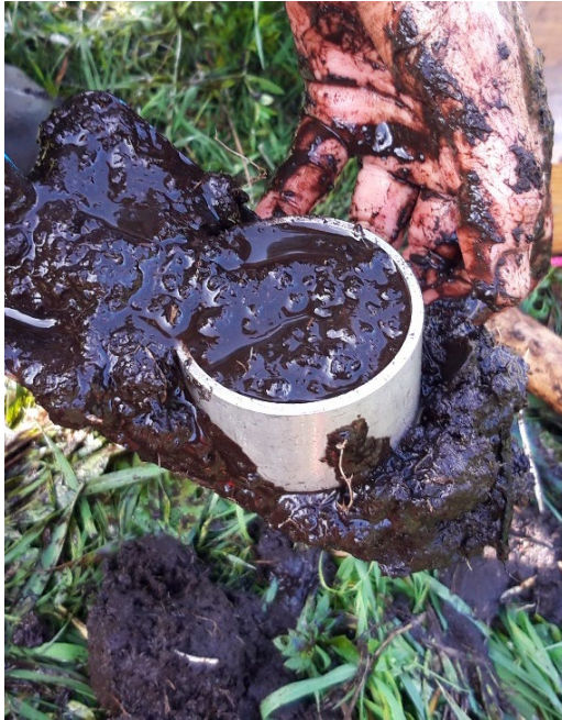
Figur 20: Ved utslemmet overflate i organisk jord skal tilsvarende volum jord smøres tilbake i sylindere (Fotograf: Teresa G. Bárcena)
