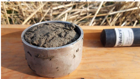
Figur 18: Denne prøven er for dårlig og må forkastes (Fotograf: Teresa G. Bårceña)
