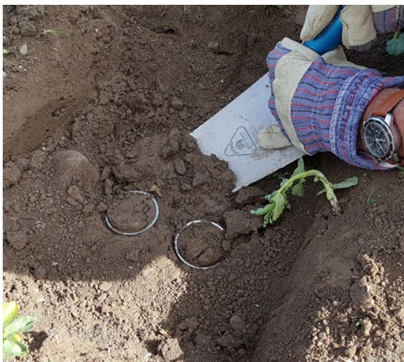
Figur 11: Sylinderne graves opp ved hjelp av murerskje (Fotograf: T. Gaardløs)
