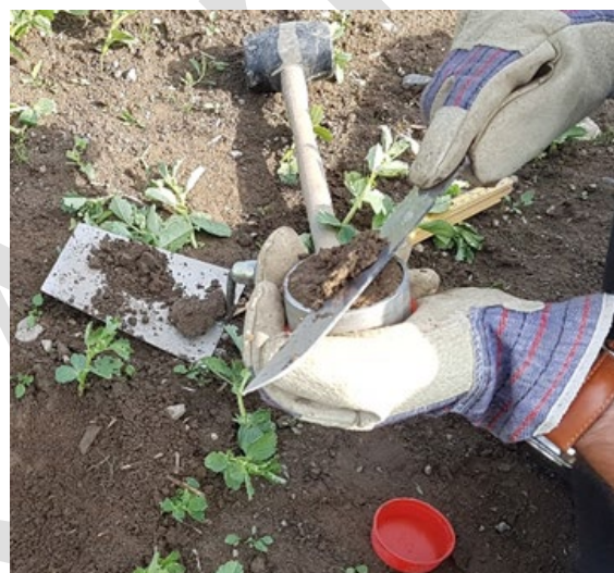
Figur 12: Overflaten av sylinderen renses og overflødig material fjernes (Fotograf: T. Gaardløs)
