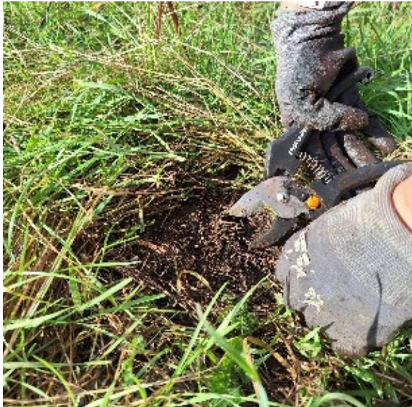
Figur 29: Overjordisk vegetasjon klippes bort før bruk av split-tube-jordbor (Fotograf: Dorothee Kolberg)
