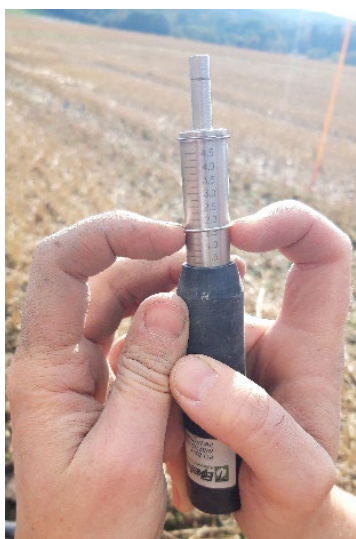
Figur 17: Les av penetrasjonsmotstand ved ringen og skyv ringen deretter tilbake til 0 (Fotograf: Teresa G. Bårceña)
