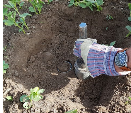
Figur 10: Sylinderne skal slås ned i jorda ved hjelp av en slagette (Fotograf: T. Gaardløs)
