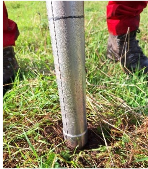
Figur 30: Split-tube-jordbor presses og dreies ned i jorda ... (Fotograf: Dorothee Kolberg)
