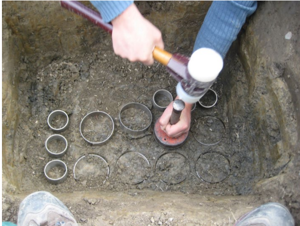
Figur 9: Sylinderne plasseres på jorda i ønsket dybde og slås forsiktig inn (Fotograf: T. Seehusen)
