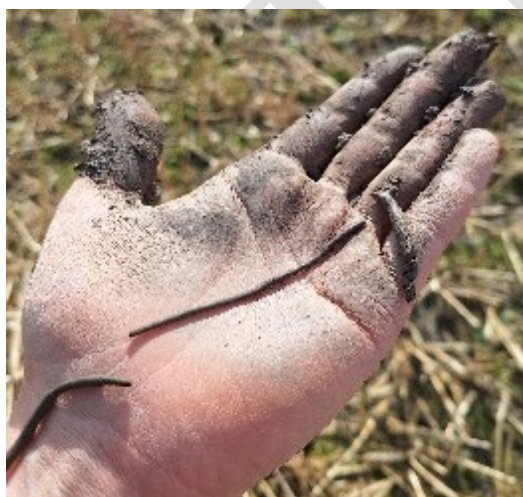
Figur 46: En jordklump rulles til en tynn pølse (Fotograf: Dorothee Kolberg).
