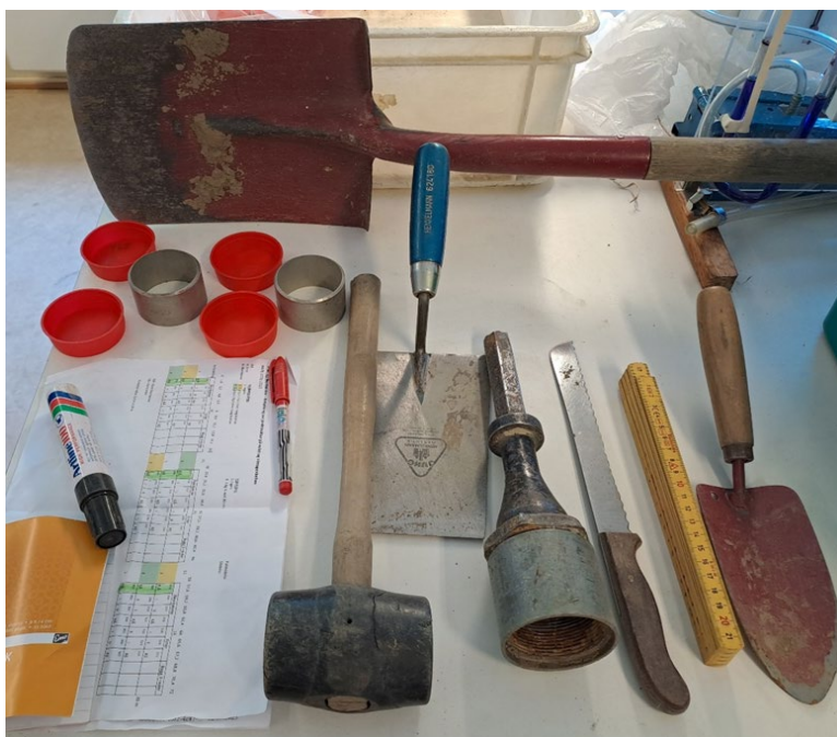
Figur 8: Feltutstyr som trengs til uttak av sylinderprøver og måling av penetrasjonsmotstand
