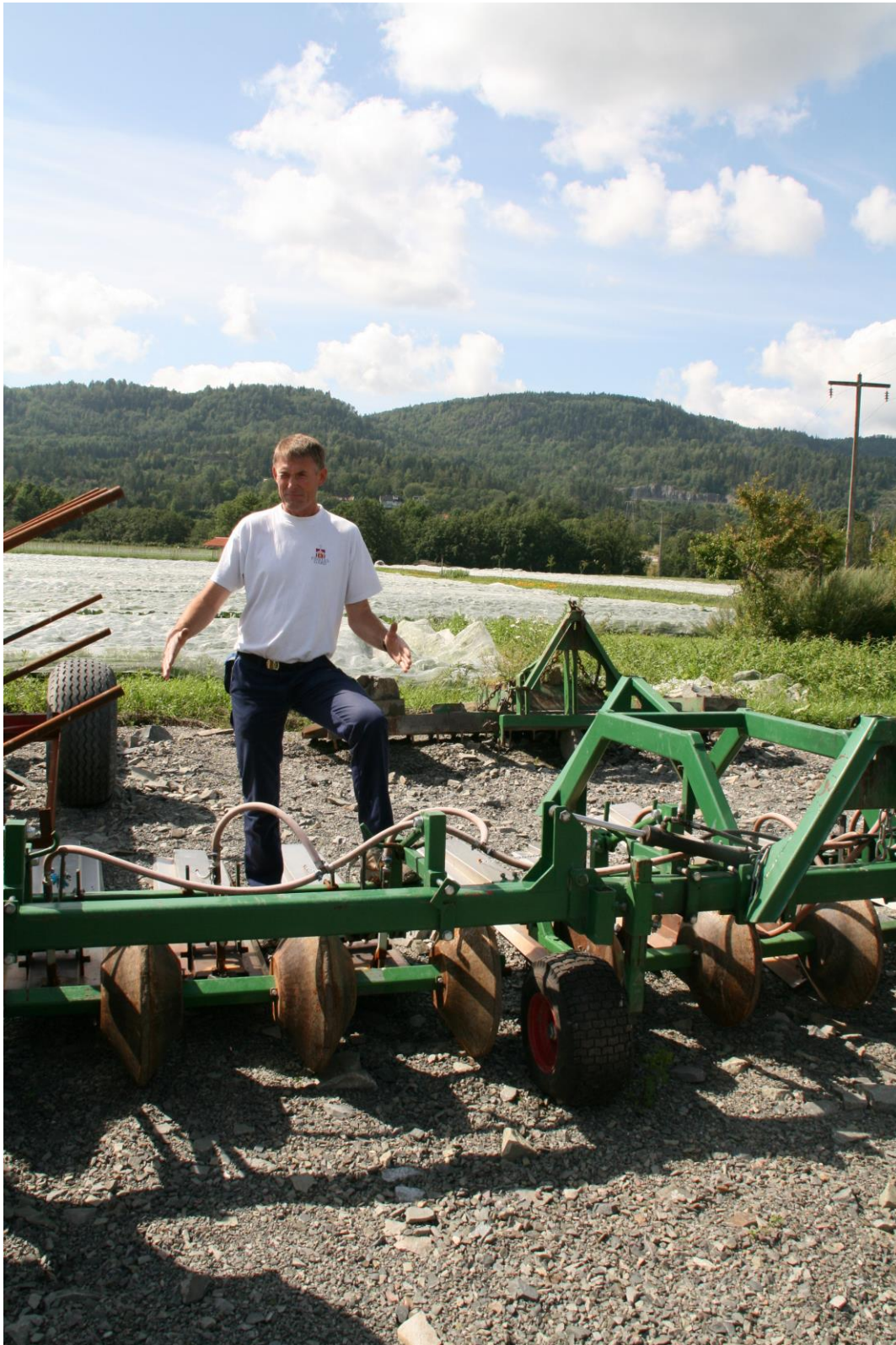
Hans Kjærås har konstruert en propanbrenner som går over tre senger. Brenneren benyttes i gulrot før den spirer, og i løk. Foto: Kari Bysveen
