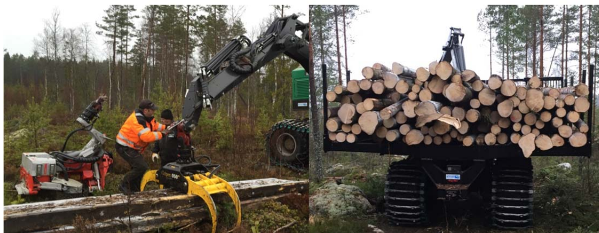
Utbygging av hogstaggregatet med klo (hurtigkobling) og maskinen fungerer som svær lassbærer. Foto: Kai Eriksen (Skogservice AS)
