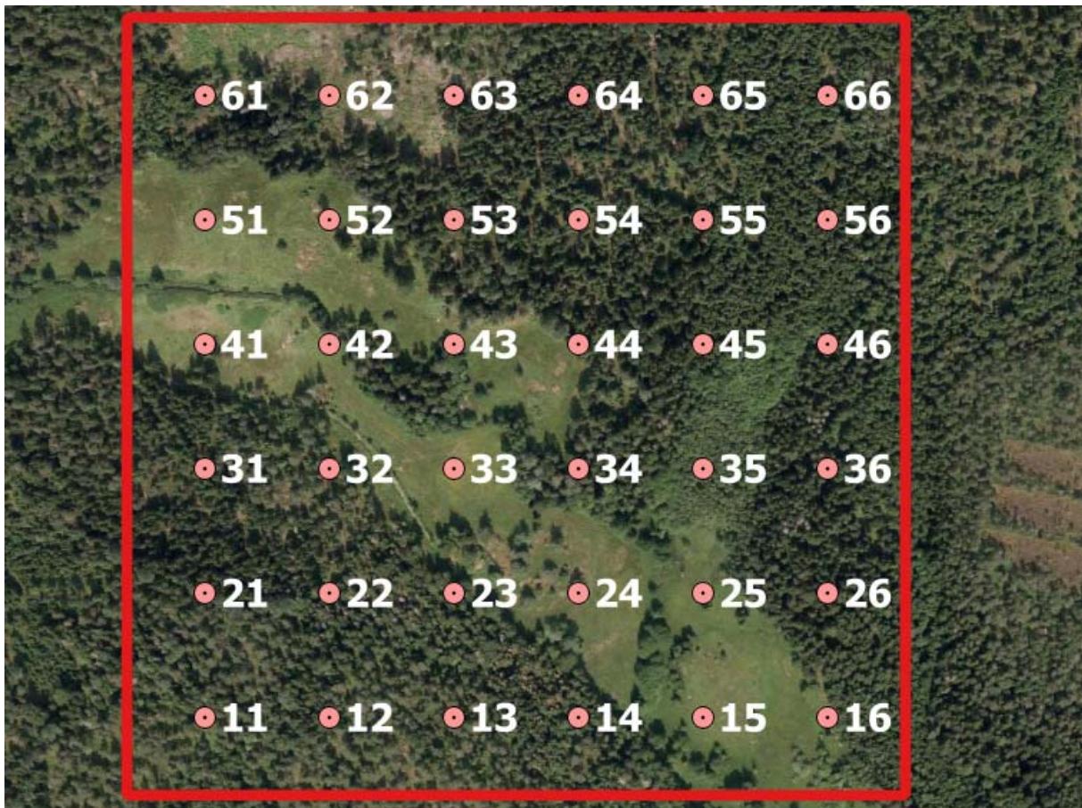
Figur 3.2: Feltflate SSB500 # 22555006634500 med 36 punkter i forband på 80 meter (Ortofoto © Norge i bilder/Norge digitalt).
