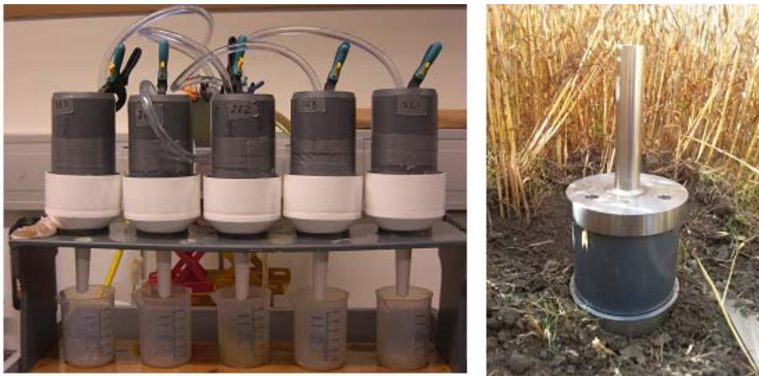
Figur 4. Apparat (t.v.) for måling av mettet vannledningsevne på uforstyrta jordsylindre som er tatt ut i felt (t.h.). Foto. Inga Greipsland
