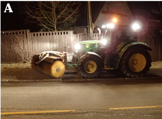
Bilde 3: Viser bilde av traktorer med roterende børste (A) og kantkost (B) som samler gateoppsopet i ranker lang veibanen for oppsamling.
