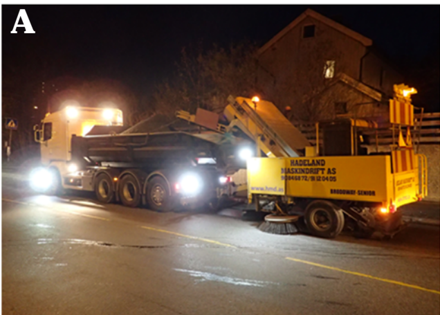
Bilde 4: Viser lastebil med oppsamlerkost (Broddway) som samler opp gateoppsop samlet i ranker (A og B). Bak oppsamlerkosten følger feie-/sugebil som fjerner gjenliggende masser og finere partikler (B).
