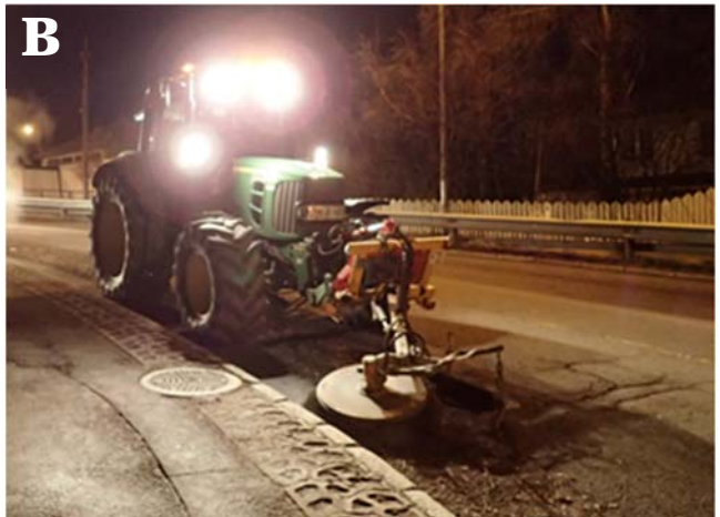
Bilde 3: Viser bilde av traktorer med roterende børste (A) og kantkost (B) som samler gateoppsopet i ranker lang veibanen for oppsamling.
