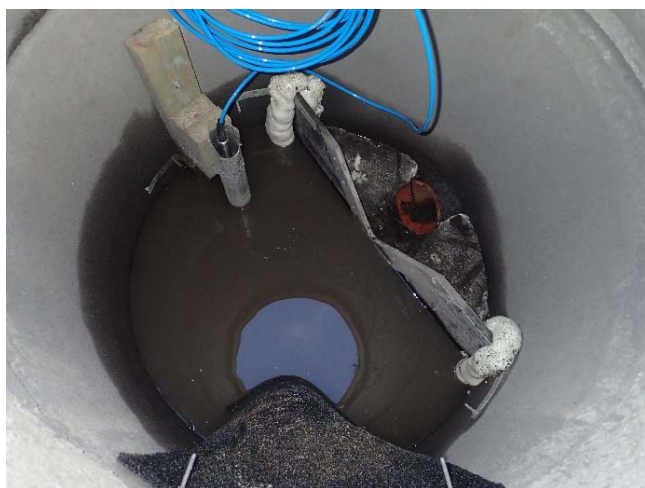
Bilde 1: Viser instrumentering med v-spor i kum før påslipp til kommunalt OV.
