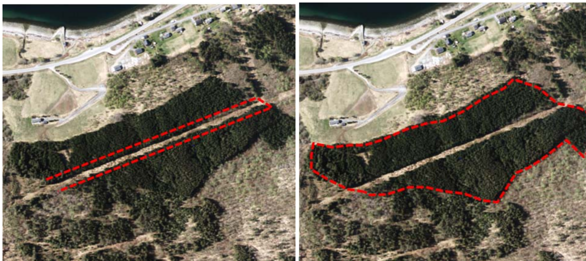
Fig. 18. Kraftgate gjennom høy og tett plantet granskog på Vestlandet. Et vanlig tiltak er utbredding av kraftgata (venstre), mens en løsning som er mindre risikabel er å samarbeide med skogeier om å avvirke hele skogbestandet (høyre).
