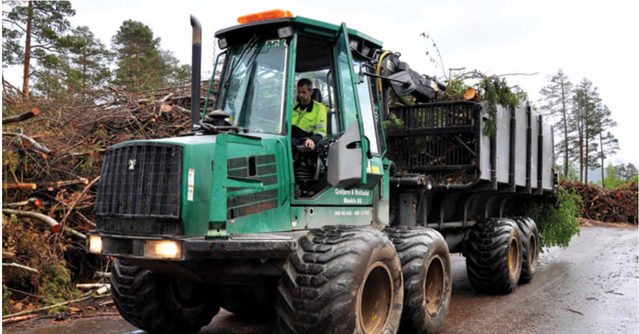
Lassbærer med GROT (greiner og topper) til veiing i Møre og romsdal. GROT er en av skogbrukets bioenergikilder. Foto: Leif Kjøstelsen, © Skog og landskap
