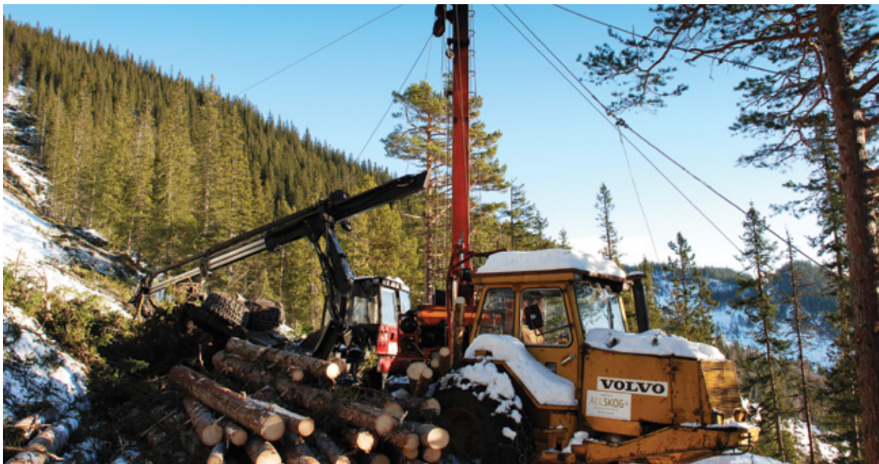
Avvirkning av tømmer foregår på ulike måter. Bildet viser taubane-drift med kabelkran. Midtre Gauldal, Sør-Trøndelag. Foto: Morten Nitteberg, © Skog og landskap
