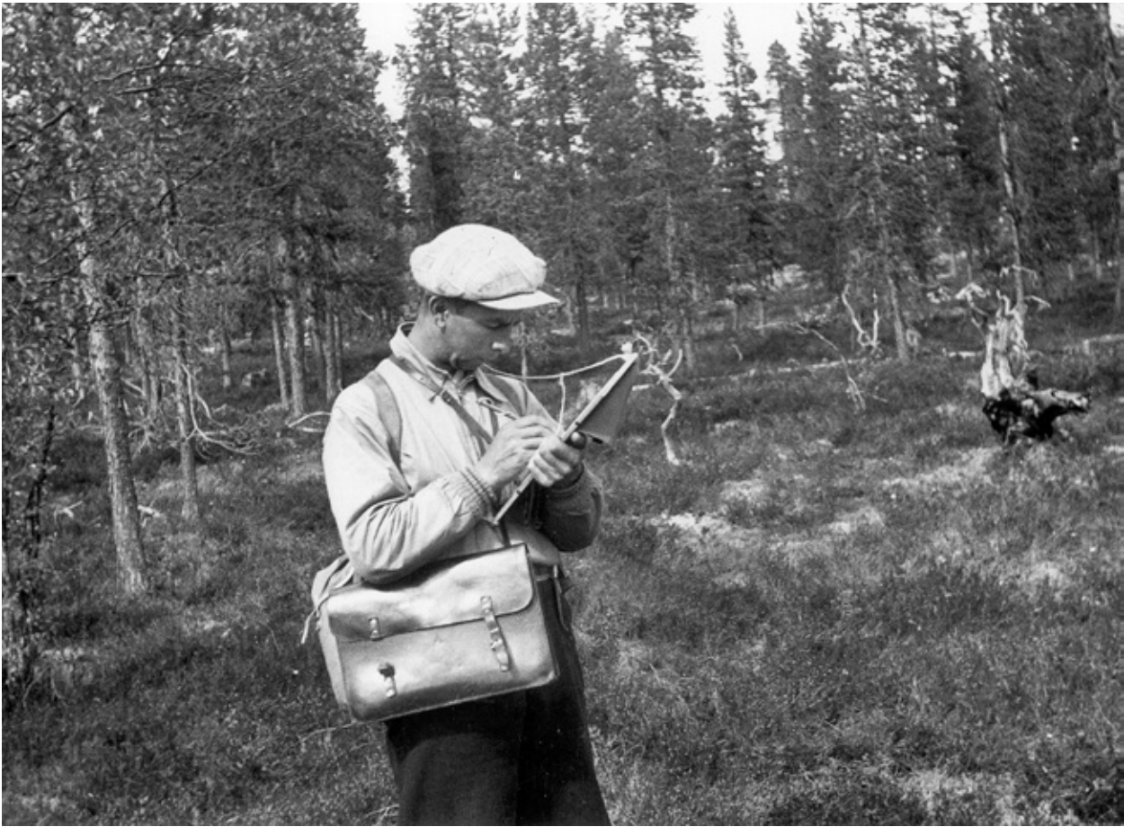
Venstre. Uttak av borprøve for telling og måling av årringer. Ut fra dette bestemmes alderen til treet og hvor raskt det har vokst. Tilvekstboret er et sentralt redskap også i dagens takstarbeid. Foto: Aasmund Vigerust, © Skog og landskap
