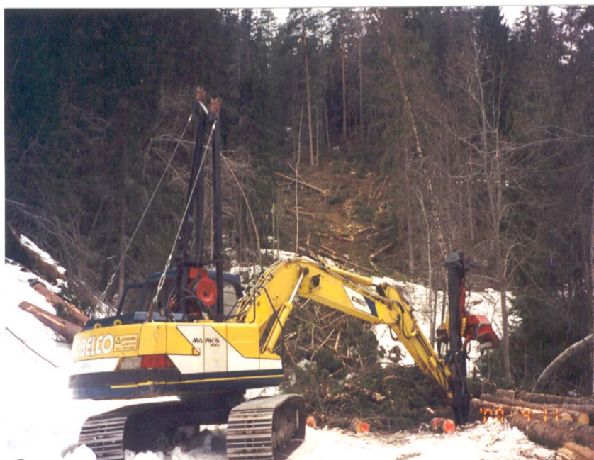
Figur 1 Bardunfri taubane utviklet på Skog og landskap ca. år 2000 -
