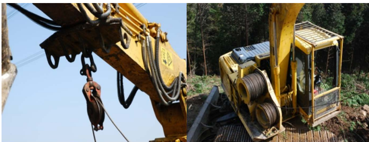
Figur 5. Oppheng for blokker og vinsjtrømler.
