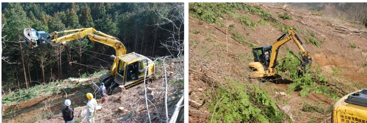
Figur 7. Swing yarder-prinsippet. Gravemaskina svinger lasset bak seg, vinsjer det inn, og en annen maskin tar lasset til opparbeidingsplass.
