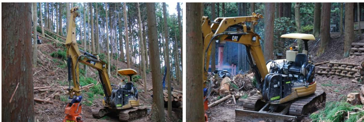
Figur 9. CAT beltegraver med tømmerklo og to-tromlet slepebanevinsj. Tårnet oppe på bildet til høyre.
