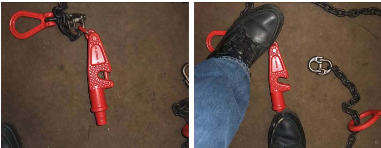
Figur 23. Selvutløsbare stropp hvor kjettingens låsepinne er fjærbelastet.
