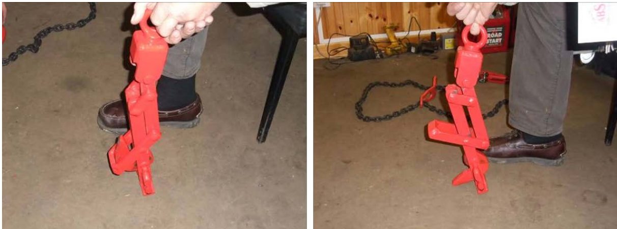
Figur 22. Selvutløsbare stropper. Lukket (strek) og åpen (avlastet).
