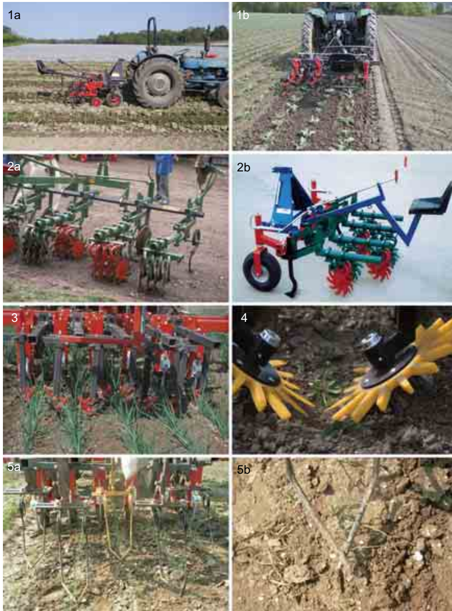
Figur 4.14 Ikke-drevne redskapstyper for radrensing og rensing i raden. 1: Skjærradrenser sett fra siden (a) og bakfra (b). Foto: Gøran Danielsberg og Mats Tobiasson (S). 2: Stjernehjulsradrenser (fabrikat: HARUWY (a) / Bärtschi-FOBRO (b)). Foto: Alf Nordby/Produsent. 3/4: Rad-fingerhjulsrensere i løk (3) og sukkerbete (4). 3: Har små hjul for kulturer med liten radavstand (fabrikat: Machinefabriek Steketee BV). Foto: Pieter Bleeker(NL). 4: Har harde hjul for tyngre jordarter og er egentlig lagd for bruk i små trær (fabrikat: KRESS). Foto: Pieter Bleeker(NL). 5 (a og b): Skrapepinnerenser (fabrikat: Moteska Industri AB) Foto: Pieter Bleeker(NL).
