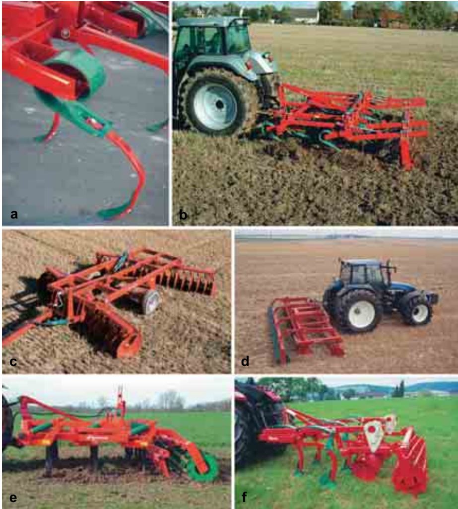
Figur 3.21 Ulike jordarbeidingsredskaper. a: Brede S-tinder. b: Stubbharv. c: Tung skålharv med V-form. d: Skålharv hvor hver skål sitter på eget oppheng. e: Stive tinder med utløsere, Q-formede tinder som etterharv. f: Skålgrubber. Fabrikat og foto alle bilder: Kverneland (gjengitt med tillatelse fra Kvernelands nettside).
