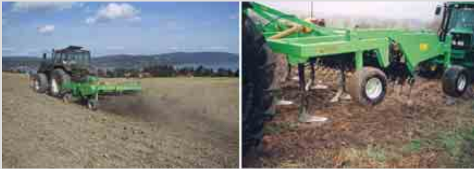
Figur 2.27 Kvik-Up harven er effektiv til å legge kvekejordstengler på jordoverflaten, men krever stor motorkraft. Foto: Silja Valand.
