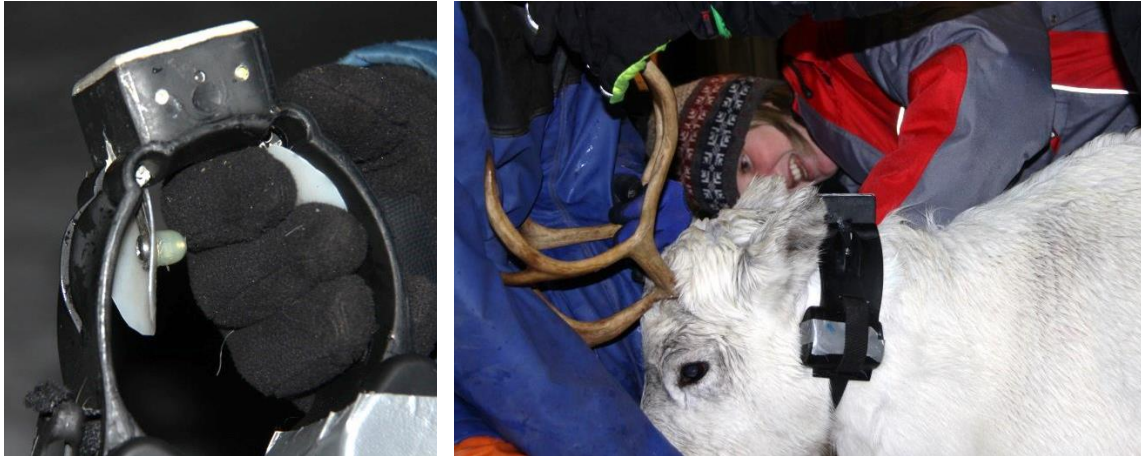
Bilde 3 og 4. Til venstre: nærbilde av NoFence-enheten med strømelektrode ved pekefinger. Til høyre: montering av NoFence-klaven.
