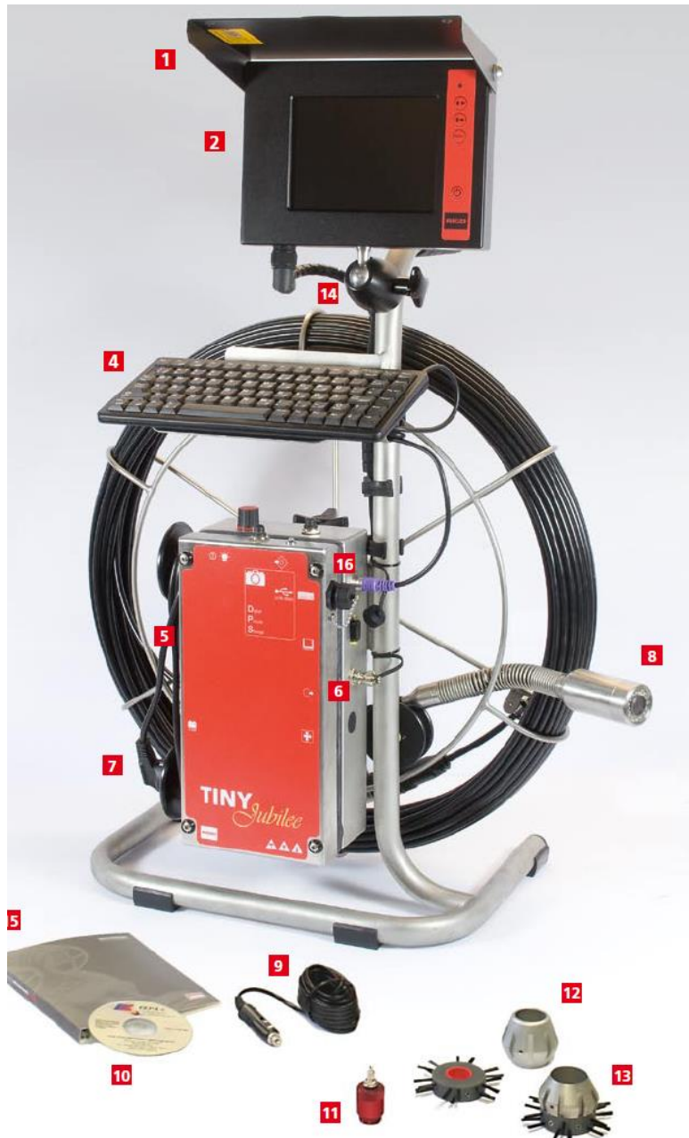
Figur: Kabelkamera med utstyr som ble brukt i registreringsarbeidet. (Bilde fra brosjyre)
