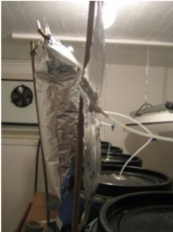
Figur 5.2 Gasspose fylt med gass utviklet fra dunk med råtnerest direkte fra råtnetank.
