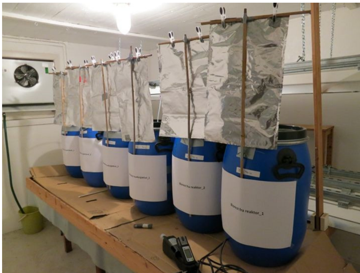
Figur 5.1 Bilde av dunker med monterte gassposer plassert på bord i klimarom
