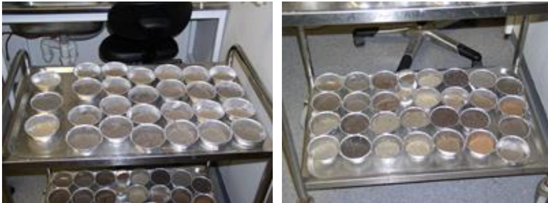
Figur 6. Lufttørking av prøver til XRF-analyse.
