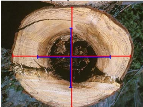
Bilde 1. (Foto: Roll-Hansen/Tun Forlag). Røde linjer er kryssklaving for estimering av diameter, blå linjer er kryssklaving for beregning av %-vis andel av diameter med sentrumsrâte
