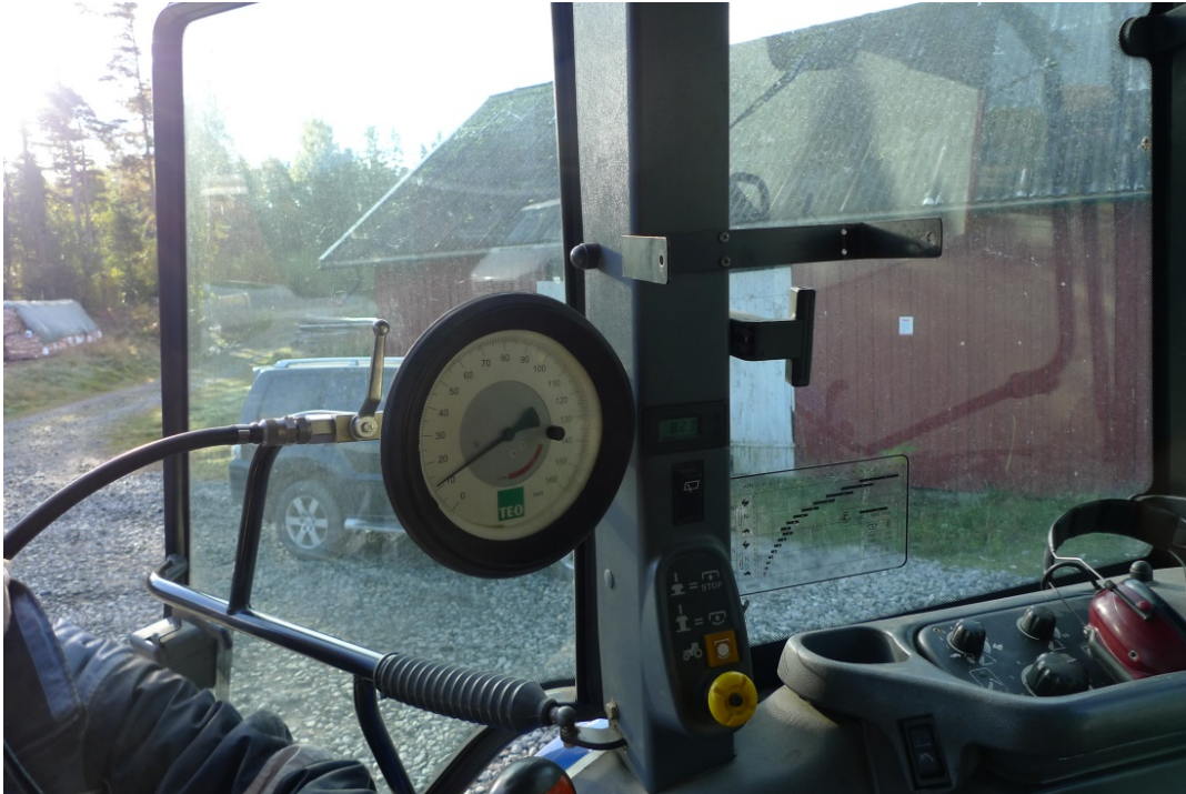
Figur 12. Teo rundballevekt med hurtigkobling for montering til frontlasterens løftesylinder. Foto: Eirik Nordhagen.
