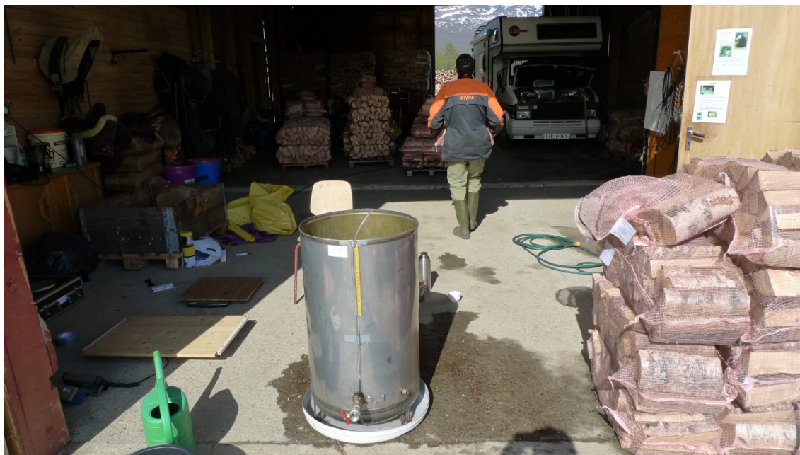
Figur 8. Dypping av sekken i varmtvannstank for utregning av volum ved i sekken. Foto: Eirik Nordhagen.
