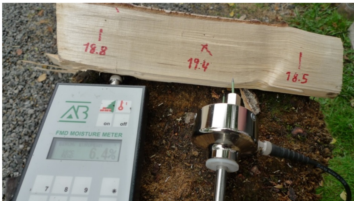
Figur 9. Fuktigheten ble målt med fuktighetsmåler på tvers av fiberretningen og på tre steder. Foto: Eirik Nordhagen.
