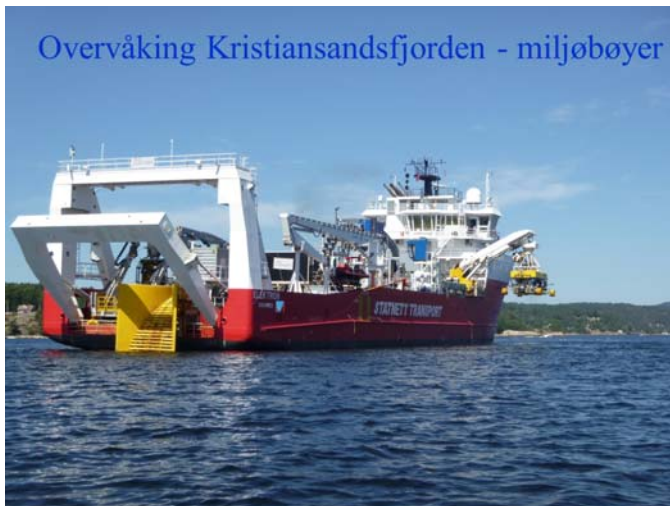
Figur 59. Viser fartøy for utlegging og nedspyling av kabel i sjøbunnen samt miljøbøye i fjorden.
