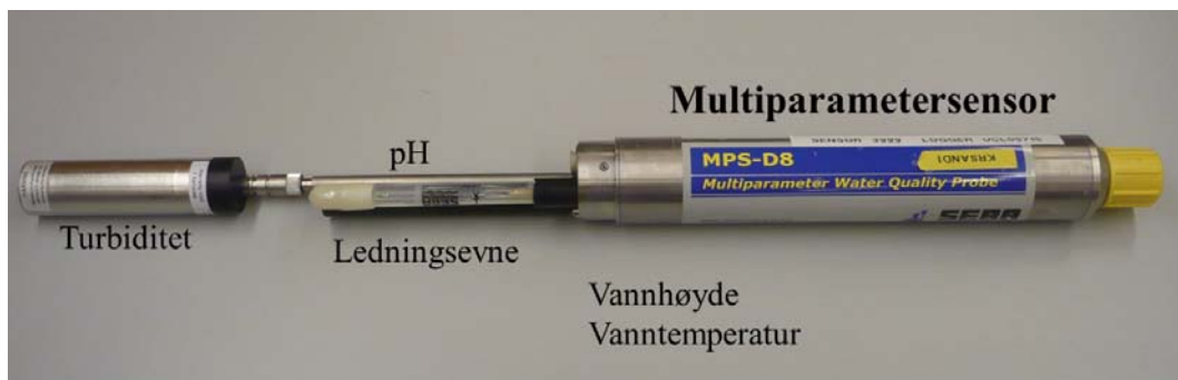
Figur 8. Multiparametersensor MPS-D8 med standard sensorer for vannhøyde, temperatur, pH, ledningsevne og turbiditet.
