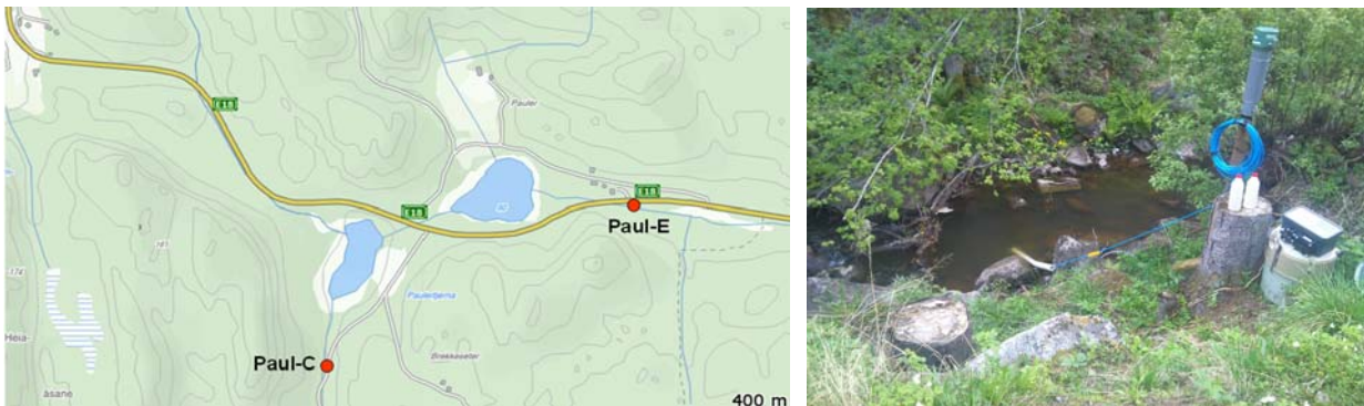
Figur 17. Viser plassering av MPS opp- (Paul-E) og nedstrøms (Paul-C) Paulertjern samt bilde av stasjonen Paul-C (nedstrøms) i Eikedalsbekken med sensor og automatisk vannprøvetaker.
