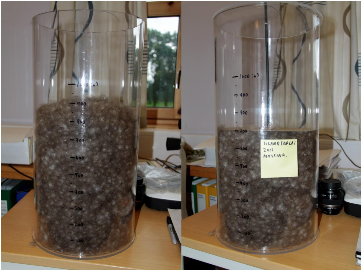
Bilde 23: Fill-power-test ved bruk av pleksiglassylinder med avmerket volumenhet (cubik inches). Et stempel med minimal vekt gjør avlesning enklere (t.h.), men duna blir noe komprimert i forhold til maksimalt utvidet ærfulgdun (t.v.)
