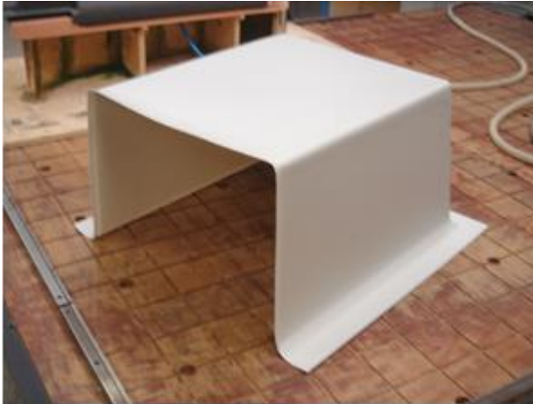
Bilde 10 og 11: Husene som ble produsert av Gibo Plast, Danmark hadde for svak konstruksjon til at stein kunne legges på taket som forankring. "Stormmattene" var heller ikke brede nok til å få en helt sikker forankring. Bildet til høyre viser et kollapset hus som følge av tyngde på taket i form av torv. Legg allikevel merke til at en ærfugl har funnet dette attraktivt og hekket i huset. Foto: Gibo Plast (venstre) og Niels Hansen (høyre).
