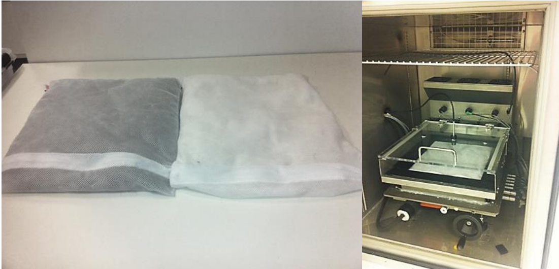
Bilde 24: Puter med 6,00 gram dun klar for isolasjonstest (t.v.). Isolasjonsevnen blir målt ved at putene ligger på en «hot plate» for en lang periode og varmetapet blir detektert på oversiden av puten (t.h.) Foto: Susie Jahren, SINTEF
