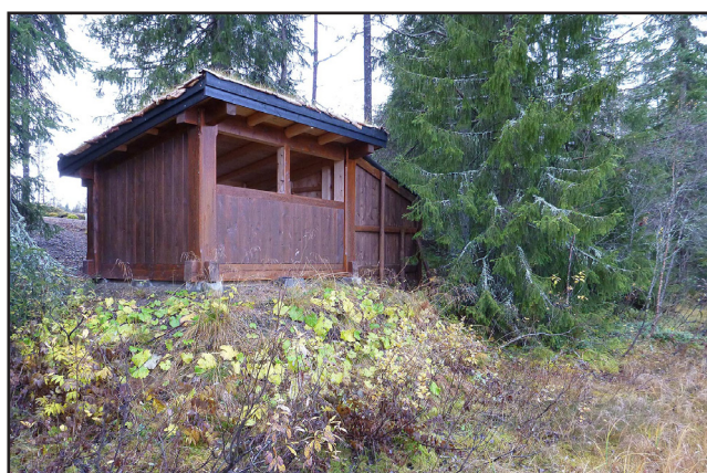
21. Enkel observasjonsbu i stavlaft på bakkenivå. Grusgulv gir gode muligheter for bruk av teleskop og fotografering med bruk av stativ. Anlegget har også en skjulvegg som gjør det mulig å ankomme anlegget mer uforstyrret.
