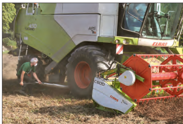
Bilde 1. John Ingar Øverland kaster oppfangerplate inn under treskeren for å registrere frøspill. Foto: Per Vestad.
