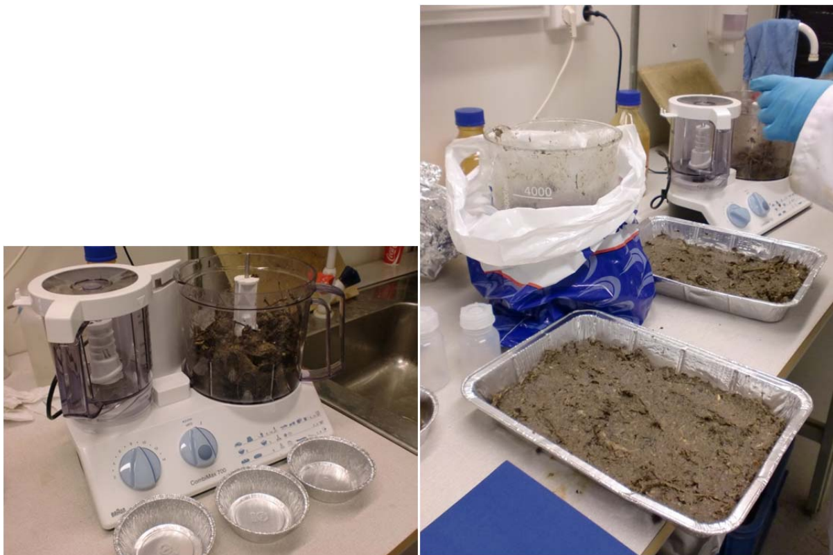
Figur 4-1: Venstre: Homogenisering av sortert organisk materiale i hurtigmikser. Høyre: fordeling av homogenisert avfall i aluminiumsformer for innfrysing og frysetørrking.
