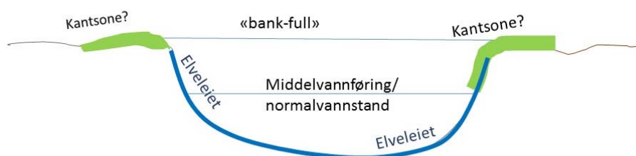
Figur 17. Illustrasjon av ulike hydrologiske begreper om vannstand i ei elv, relatert til «normalvannstand» benyttet i PT-forskriften.
