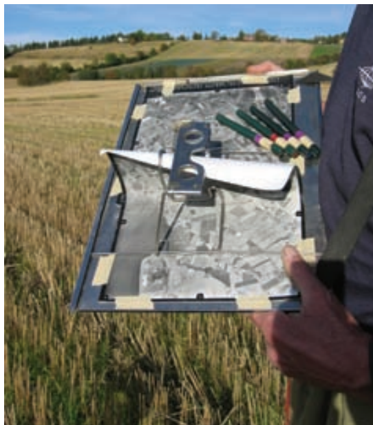
Figur 2-26 Utbredelsen av jordtypene ble tegnet inn på flybilder i felt i en stereomodell. Dette dannet grunnlaget for den videre digitaliseringen inne
