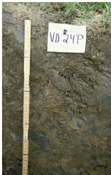
Figur 91. Vertikalt snitt av planert jordsmonn. Det opprinnelige jordsmonnet er forstyrret eller fjernet. I jorda vil det ofte være en blanding av A-, B- og C-sjikt. Jorda er tett og massiv, noe som hindrer vanntransport og rotutvikling i jorda. Foto: Eivind Solbakken.
