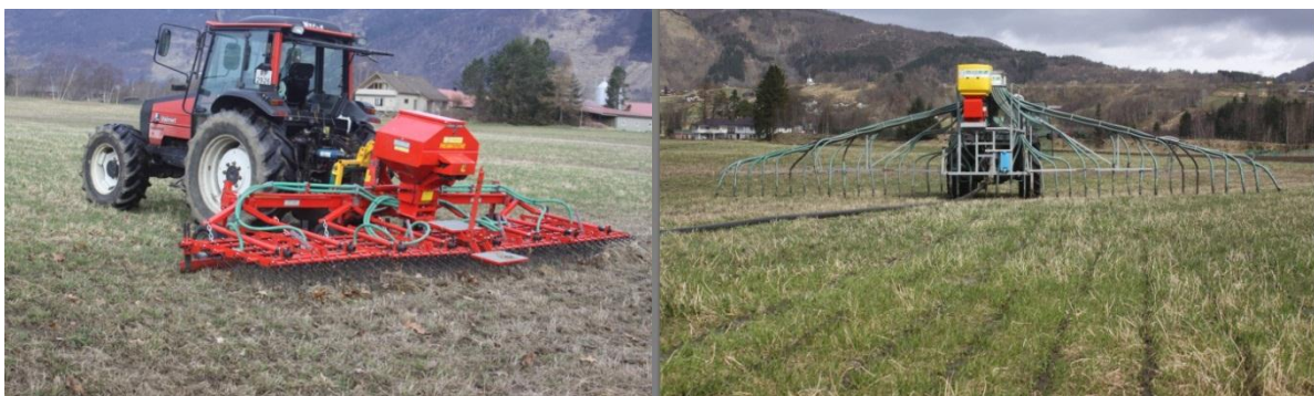
Figur 4. Bilete av utstyr som vart nytta. Einböck Pneumatic (6 m såbreidd) til venstre og ei tidleg utgåve av Agromiljø sin stripespreiar(10 m brei) med såaggregat til høgre.
