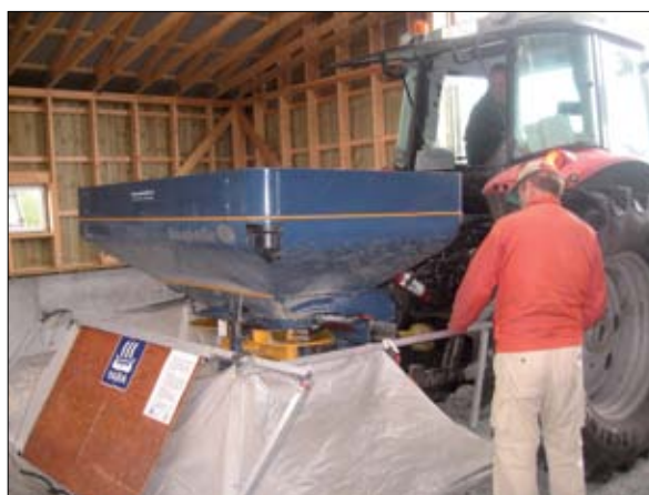
Figur 1. Kontroll av sentrifugalspredere for mineralgjødsel. Foto: Johan Ellingsen.
