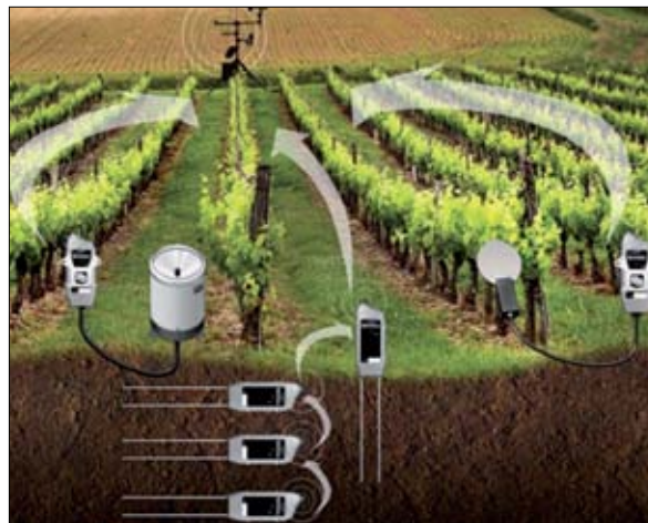
Figur 2. Illustrasjon av trådløst sensornettverk. Ill.: Campbell Scientific.
