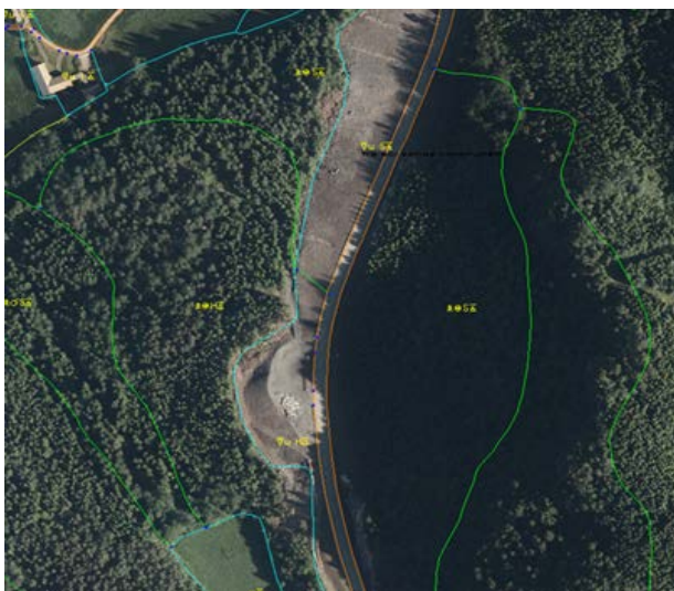
Bilde 20. Veianlegg der området rundt er betydelig opparbeidet. Det er skjedd store forandringer med grunnforholdet. Vi mener det er riktig at slike arealer klassifiseres som åpen fastmark med grunnforhold «konstruert».
