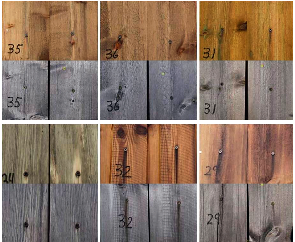
Fargeendring og gråning på ulike treslag og behandlinger etter henholdsvis 3 måneder (øvre halvdel) og 3 år (nedre halvdel). Øvre rad fra venstre: ubehandlet gran (35), ubehandlet furu (36), Royalbehandlet furu (31). Nedre rad fra venstre: acetylert furu (34), varmebehandlet furu (32), furfurylert furu/Kebony (29).
