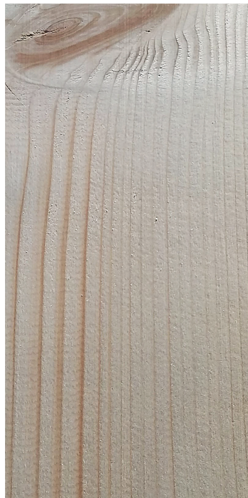
Ulikhet i overflatestruktur på samme planke som er sagskåret (til venstre) og høvlet.
