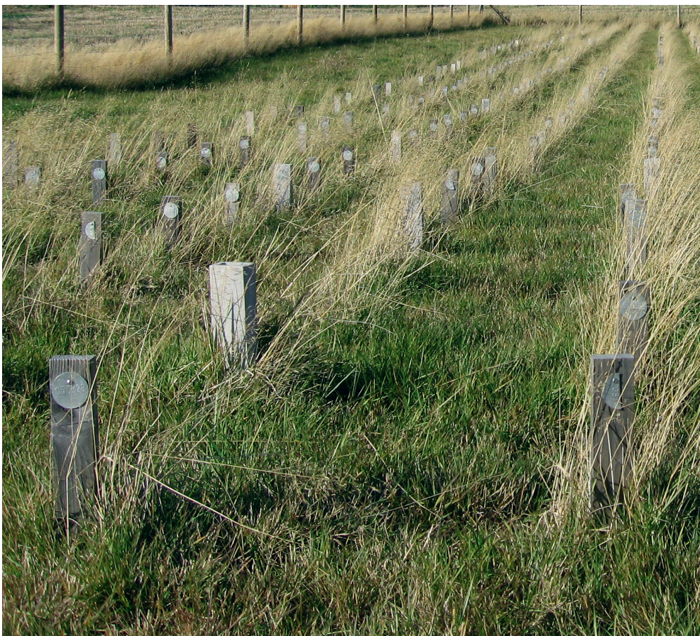
Felttest (EN 252) for holdbarhet av ulike treslag og behandlinger, Ås. Bilde: NIBIO/Gry Alfredsen
