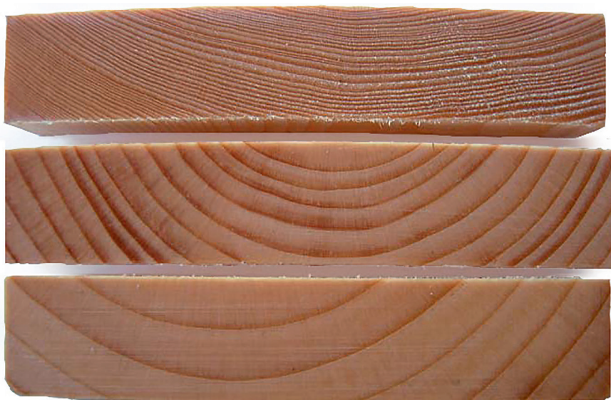
Granprøver med ulike årringbredde. Bilde: Per Otto Flæte
