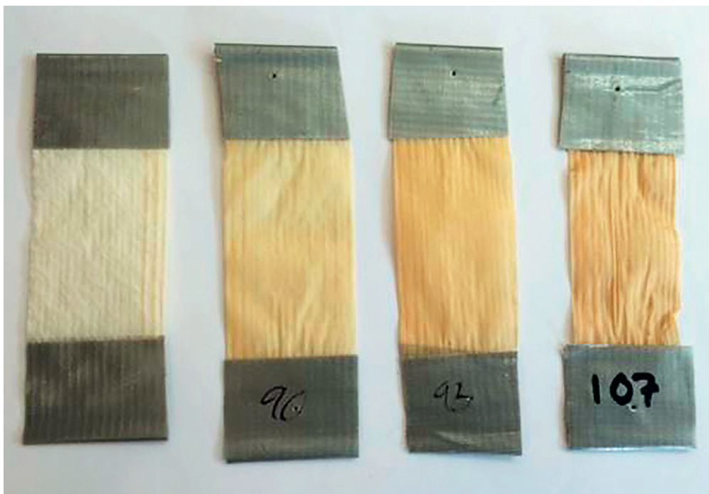
Tynn granfiner (100 mikrometer tykke) eksponert for sollys i 0, 1, 5 og 20 dager. Bilde: NMBU/Ingunn Burud
