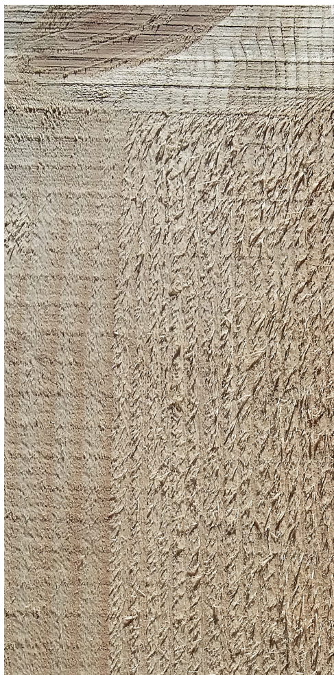
Ulikhet i overflatestruktur på samme planke som er sagskåret (til venstre) og høvlet.
