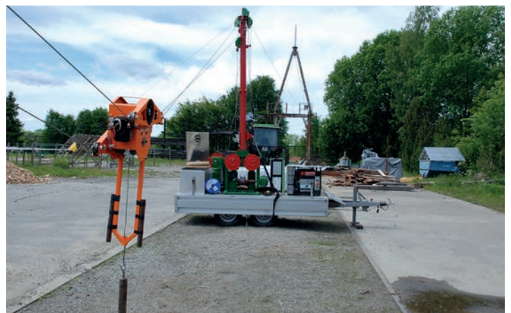
Testing av løpekatt på Owren 400 minitaubane (Foto: Morten Nitteberg)
