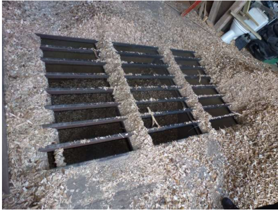
Figur 6. Tippettsjakt for flis med rist, reduserer risikoen for store ved-biter eller fremmedlegemer som blokkerer matesystemet.
