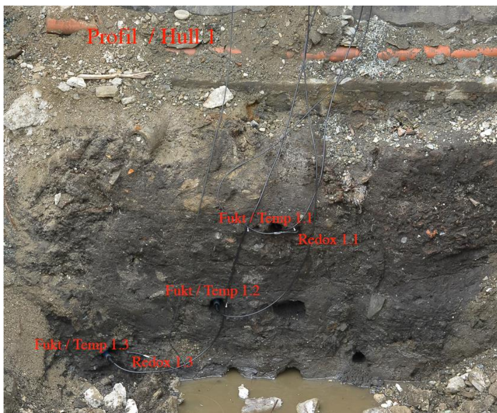
Figur 2. Plassering av sensorer i profil 1 hull 1, Munkehaugsveita (Foto: NIBIO Ove Bergersen).
