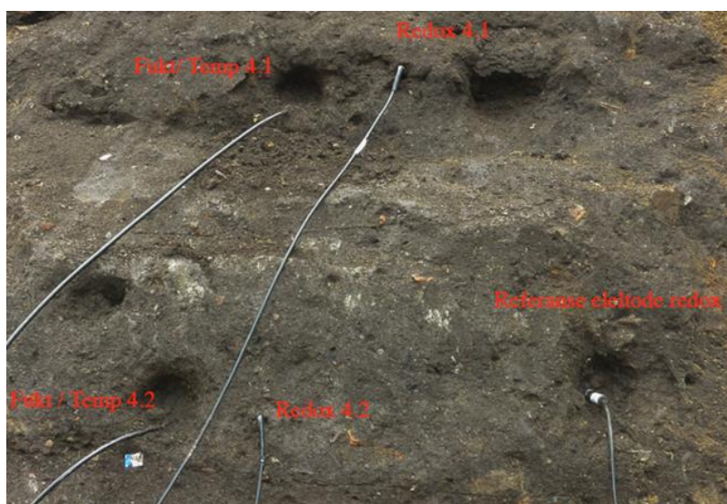
Figur 3. Innstilling av sensorer i Profil 1 Hull 4, Munkehaugsveita. Referanse-elektroden til redoks sensorene ble plassert til høyre for sensorene 4.2. (Foto: NIBIO, Ove Bergersen).
