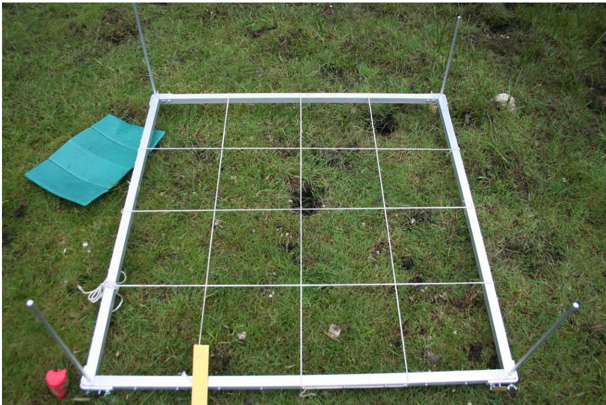
Figur 9. Fastrute for vegetasjonsovervåking, 1m 2 . Ruta er merket med aluminiumsrør i hvert hjørne. Det er satt ned en rød merkepinne i venstre, sørligste hjørne. Foto 08.07.11, ES.
