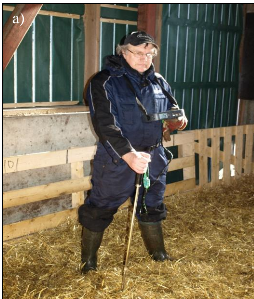
Figur 5 a, b. Måling av tallens dybdetemperatur ved bruk av et spesiallaget termometer som måler temperaturen samtidig for hver 10. cm fra overflaten og ned til 40 cm dybde. Dybdemålinger ble foretatt på totalt seks punkter og 5 dybder innen hver bing (foto: C. Uhlig).
