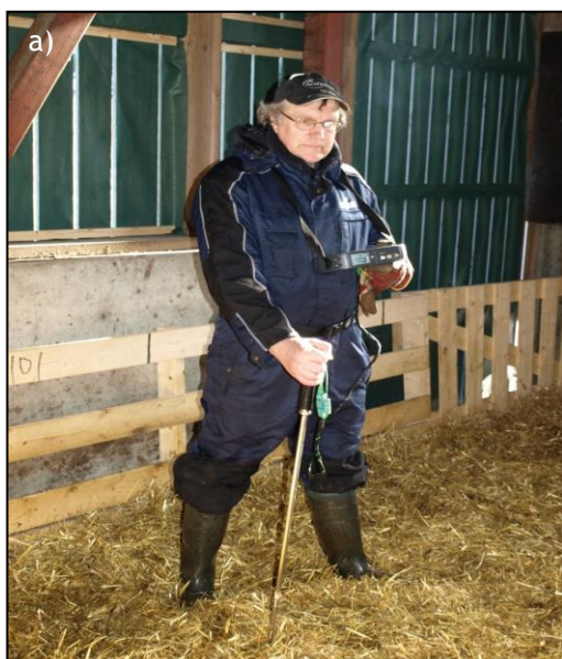
Figur 4 a) og b). Måling av tallens dybdetemperatur ved bruk av en spesiallaget temperaturstav som målte temperaturen for hver 10. cm fra overflaten og ned til 40 cm dybde (foto: C. Uhlig).
