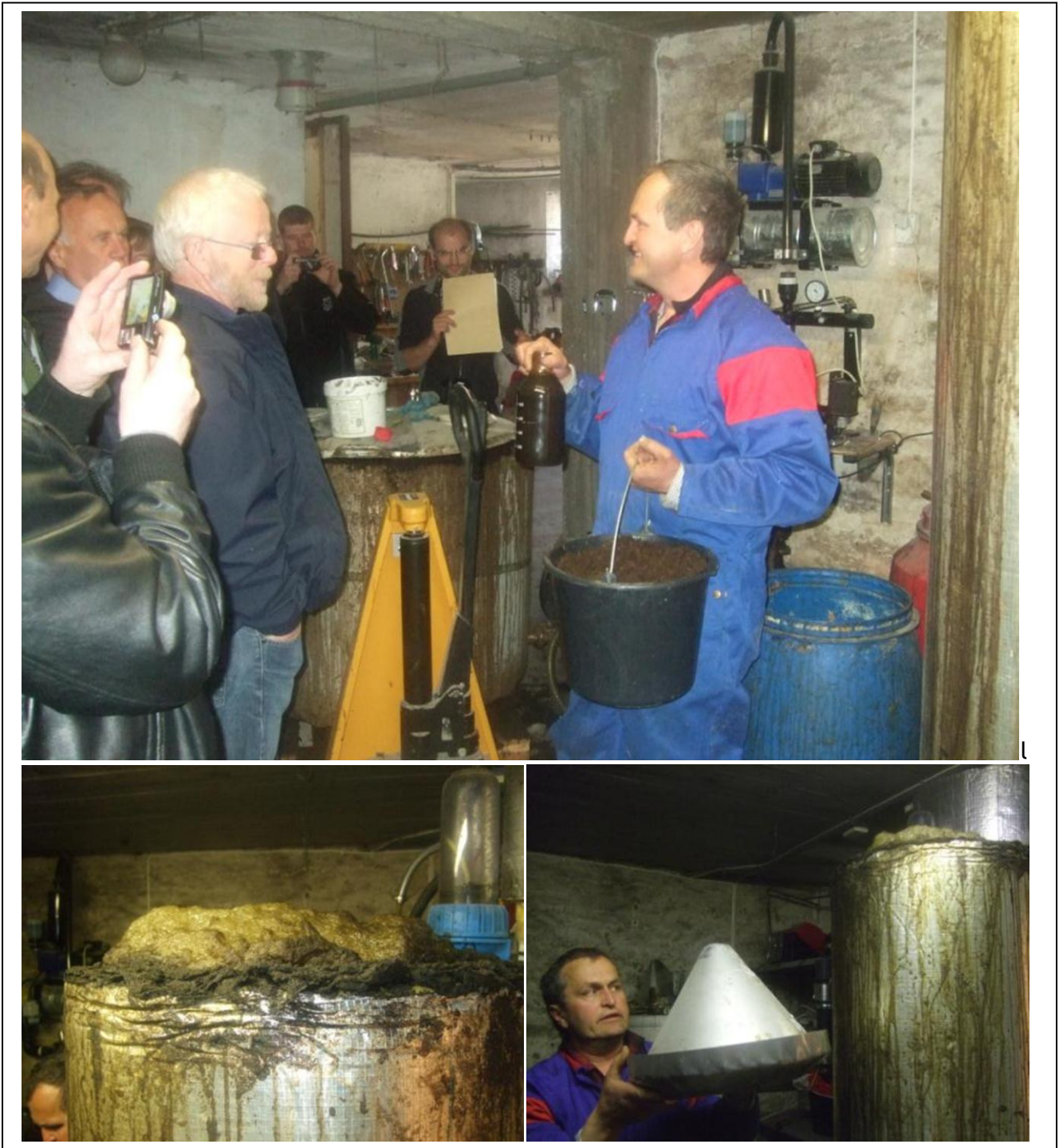
Øverst: Knut Vasdal viser fram de to fraksjonene som trommelseparatoren produserer. Nederst: God skumming i nitrifiserings-reaktoren. Foto: AK Løes.
