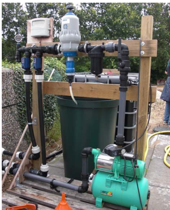
Bilde 19. Opplegg for dryppvanning med tank for stamløsning, pumpe og gjødselinjektor. Ramborg brukte tørrgjødsel i kombinasjon med en næringsløsning med lavt ledetall (NPK + mikro). Foto: Nina Opstad
