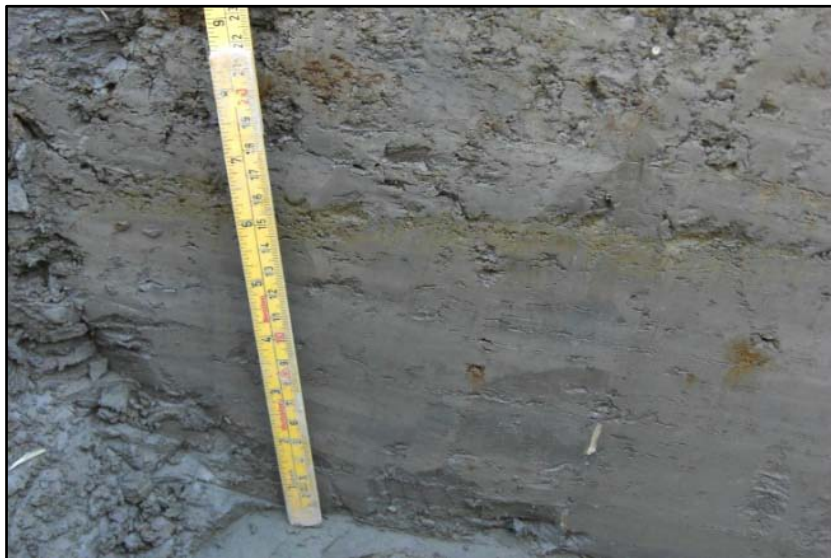
Figur 18. Jordprofil (øvre 50 cm) på planert jord ved rutefeltet i Askim. De øvre 30 cm er påfylt masse. Under matjordlaget er jorda svært massiv, med få synlige makroporer (nederste bildet). Foto: R. Pedersen, Bioforsk.
