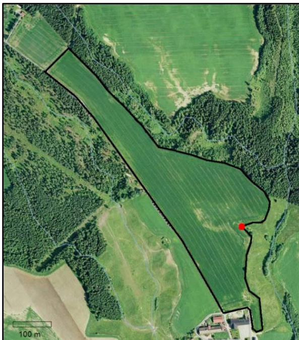
Figur 6. Vandsemb i Nes, Akershus. Nedbørfelt for overflatevann er noe mindre enn og ligger innenfor den svarte linja, som representerer areal som dreneres av grøfter.
