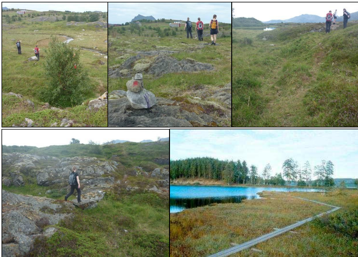
Figur 47. Stien er merket med røde treskilt som henger i trær (øverst t.v.) eller med steinvarder (i midten); utydelig stimerking (pkt. 261) (t.h.), Bløte partier kan sikres med stein hvor det passer naturlig i landskapet (nederst t.v.) eller klopper (nede t.h.) (foto: A. Bär, unntatt nederst t.h. DN 2006, R. Boe).
