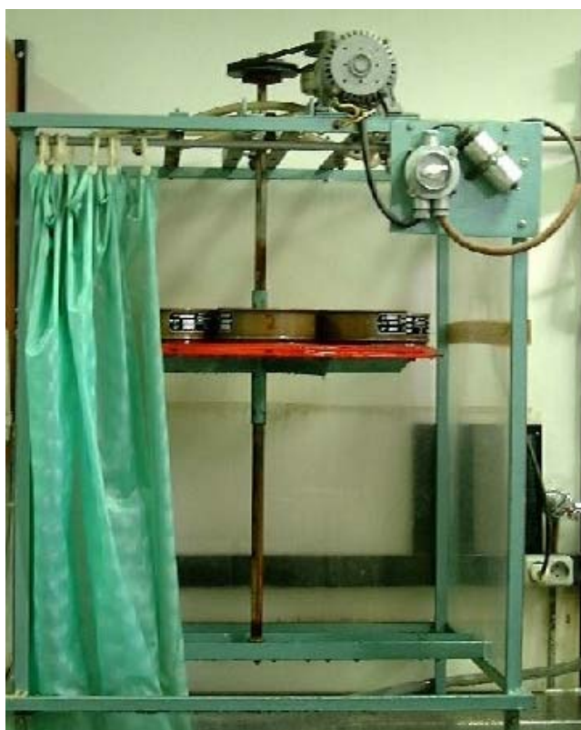
Figur 2-2. Regnsimulatoren som ble brukt til måling av aggregatstabilitet.
