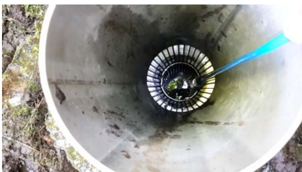
Figur 13. Multiparametersonde for automatisk overvåking av grunnvann i kilde.
