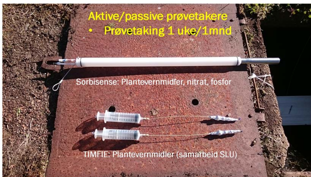
Figur 47. Aktive prøvetakere, TIMFIE og Sorbisense, prøvd ut for grunnvann i en gammel brønn i Råde med stor risiko for tilførsel av plantevernmidler fra dyrka mark.
