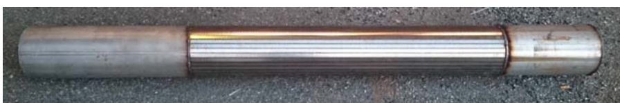
Figur 12. Prefabrikkert prøvetakingsbrønn kildeutspring: 0,3 m bunnseksjon, 1 m con slot 0,5 mm og 0,5 m stigerør på toppen. Rustfri utførelse.
