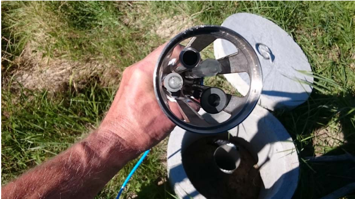
Figur 5. Multiparametersensor (MPS) for måling av grunnvannsstand, vanntemperatur, pH, ledningsevne, oksygen og redoks.
