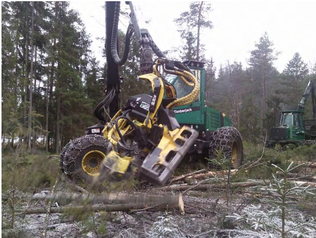
Bilde 11. Hogstmaskinen avvirker skog langs traseen som opparbeides over geonettet. Foto: Anders Eid Hohle. 2010.
