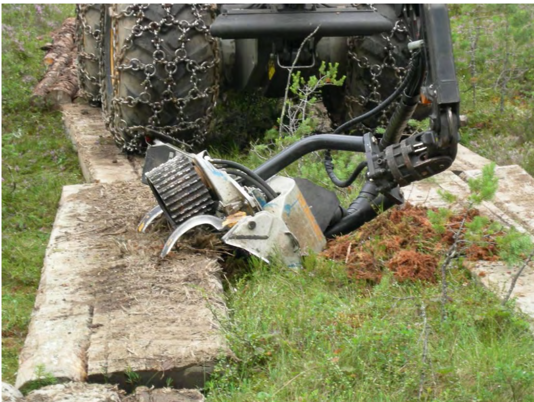
Bilde 7. Utfordring når hogstmaskinen er smalere enn lassbæren; lemmene må dras sammen. Foto: Anders Eid Hohle, 2010.
