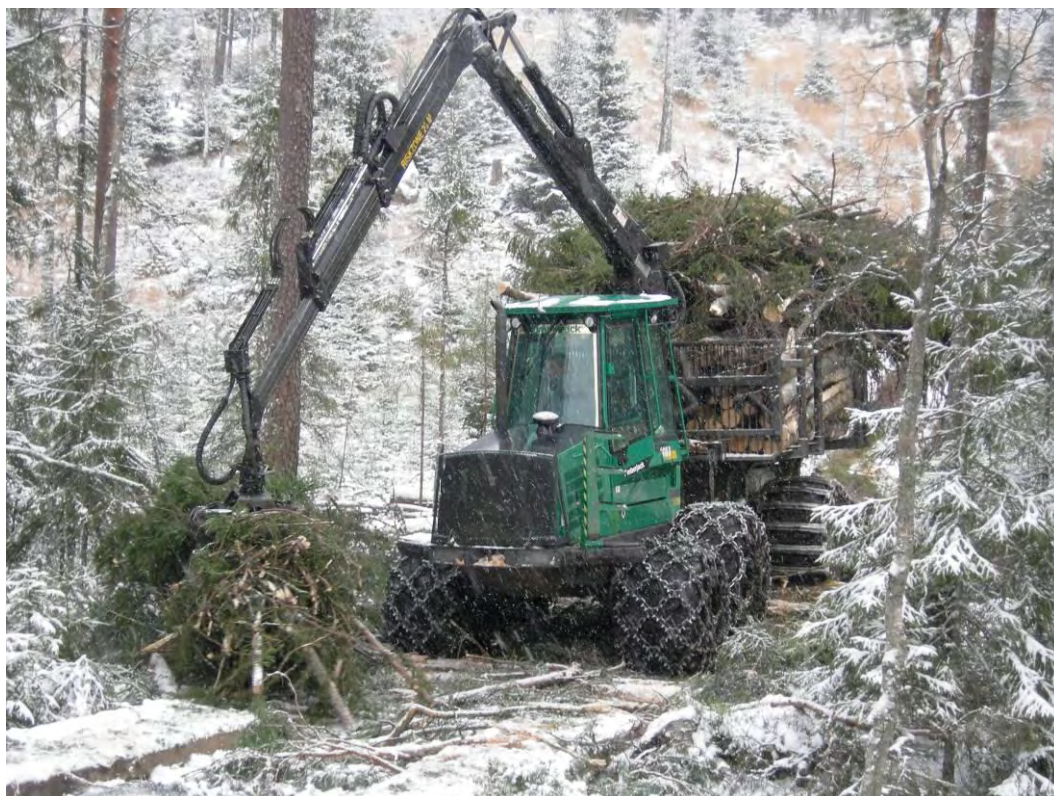
Bilde 12. Supplering med kvister/topper under drifta. Foto: Anders Eid Hohle. 2010.
