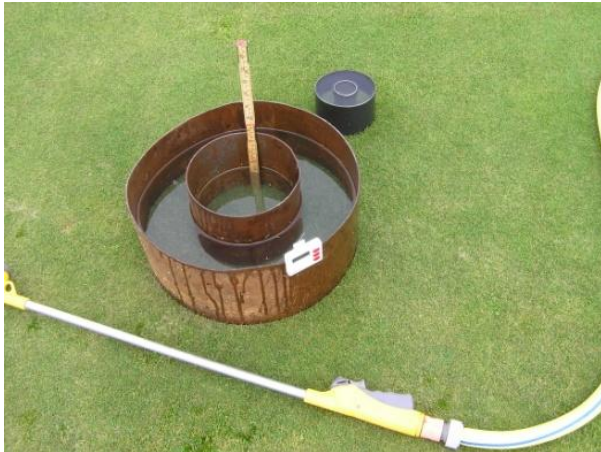
Bilde 3. Dobbelttringinfiltrometre brukt ved måling av infiltrasjon 2. oktober 2007.
