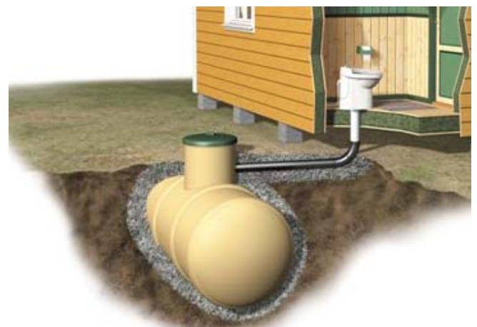
Nedgravd tett tank for klosettavløp
