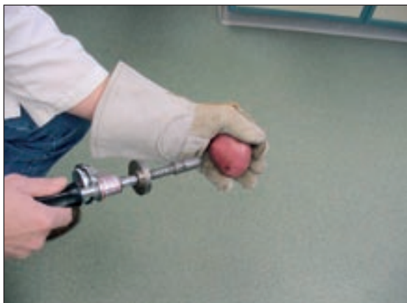
Figur 1. Måling av skallfasthet med Torquometer.
