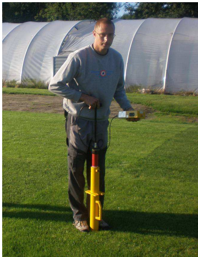
Bilde 10. Måleinstrumenter brukt i forsøka på Landvik og Apelsvoll. Øverst (a): Skjærfasthets- ('traction')-måler; Nederst (b): Clegg Impact Hammer brukt til å måle hardheten av spilleflaten Begge fotos: Trygve S. Aamlid
