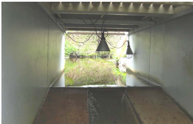
Figur 2. Målerenna - Crump-overløp. Foto: Bioforsk
