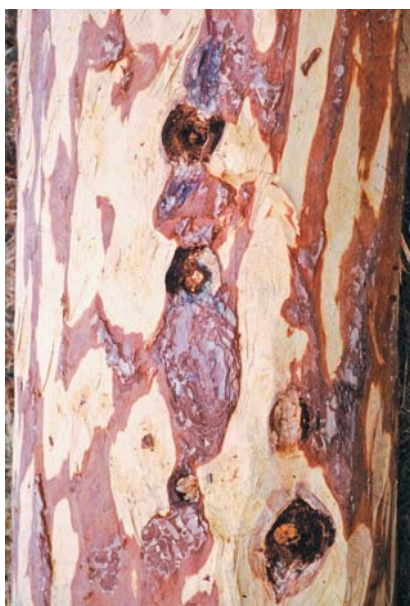
Fig. 30. Brunaktig soppmasse "tikker" ved kvisthull er et godt kjennetegn på råten innåfor. Foto: Roll-Hansen
