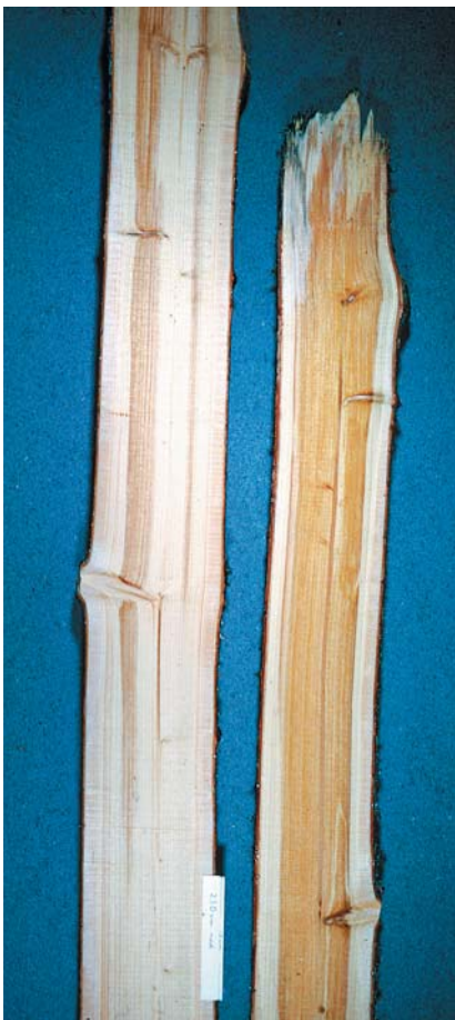
Fig. 25. Typisk råteutvikling etter toppbrekk i gran. Foto: Roll-Hansen
