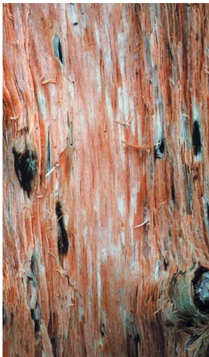
Fig. 9. Råte forårsaka av rotkjuker i gran er svært karakteristisk med kvite flekker av ren cellulose som gjerne er omgitt av svarte flekker med melaniserte sopphyfer. Foto: H. Solheim
