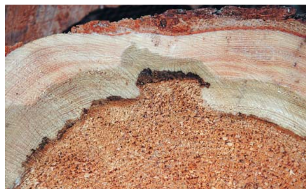
Fig. 29. Ytterst i råten forårsaka av granstokkjuke mot reaksjonssona er det ofte en mørkebrun sone. Foto: H. Solheim
