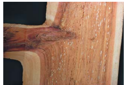
Fig. 27. Råte forårsaka av furustokkjuke med de karakteristiske kvite celluloseflekkene. Foto: Roll-Hansen
