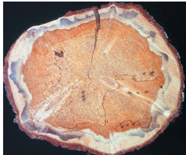
Fig. 27. Råte forårsaka av furustokkjuke med de karakteristiske kvite celluloseflekkene. Foto: Roll-Hansen
