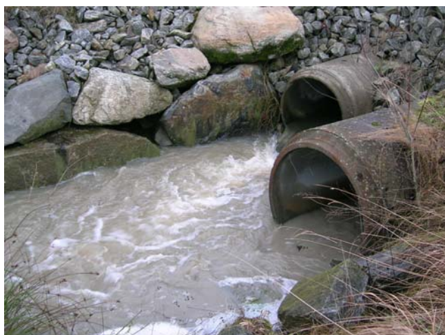
Målerør i Heiabekken. Vannføring beregnes på bakgrunn av vannhøyde og kjent vannføringsformel for røret (Foto: A. Pengerud).
