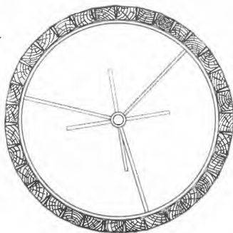
Fig. 4. Formen færdig før støpning
